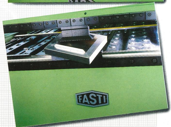
Klavierschienensysteme in der Oberflanke für mehrseitig zu kantende Werkstücke
