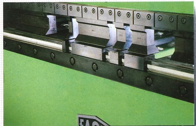
Klavierschienensysteme für Unter- und Biegeflanke für gegenläufige und innenliegende Kantungen
